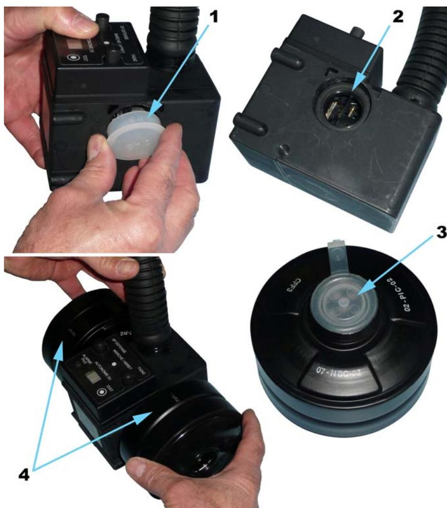
Fig. 27-12 : Installation des cartouches filtrantes sur la CVFE
