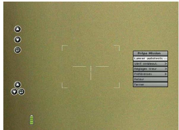
La séquence des autotests démarre. Cette séquence est constituée de messages demandant à l'opérateur d'effectuer des actions (appuis sur les boutons) dans un temps donné (10 s) ou de valider l'affichage. Le pourcentage des tests effectués apparaît sur un bargraphe situé au bas de l'écran. La valeur de ce pourcentage change à la fin de chaque étape :
