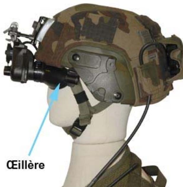
Fig. 13-4 : Position optimale de la JVN
