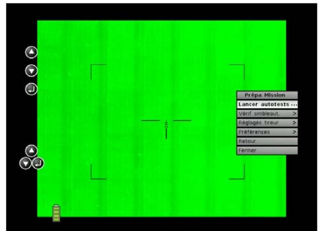
La séquence des autotests démarre. Cette séquence est constituée de messages demandant à l'opérateur d'effectuer des actions (appuis sur les boutons) dans un temps donné (10 s) ou de valider l'affichage. Le pourcentage des tests effectués apparaît sur un bargraph situé au bas de l'écran. La valeur de ce pourcentage change à la fin de chaque étape :
