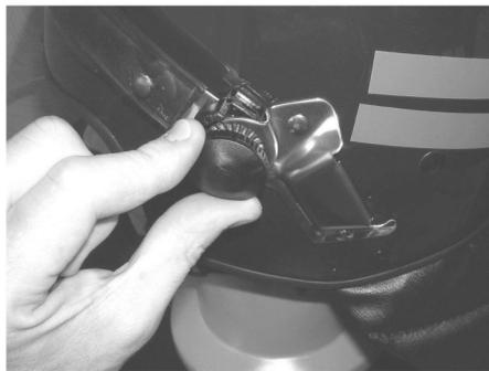
Visser l'écran avec le bouton (la rondelle doit être entre le bouton et la coquille).
